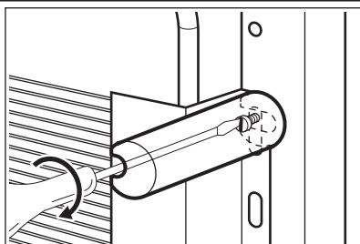
Внутри прибора есть две прокладки, которые следует установить как показано на рисунке. Ослабьте винты и вставьте прокладки под их головки, после чего затяните винты.
