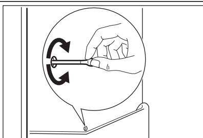
При нормальных условиях эксплуатации удаление иея с испарителя холодильной камеры происходит автоматически при каждом выключении компрессора. Талая вода стекает через сливное отверстие в специальный поддон, установленный с задней стороны прибора над компрессором, а затем испаряется. Необходимо регулярно прочищать сливное отверстие, находящееся в середине канала холодильного отделения, во избежание накопления воды и попадания капель на находящиеся внутри продукты.
