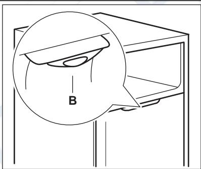
Вентилятор динамического охлаждения воздуха (Dynamic Air Cooling — DAC) позволяет быстрее охлаждать продукты и поддерживать более равномерную температуру внутри холодильного отделения.
